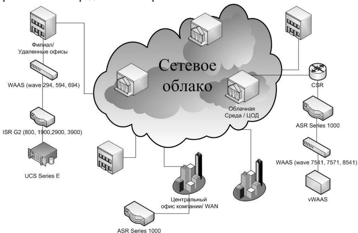
Рис. 1. Структура оборудования корпоративной сети для построения облака
