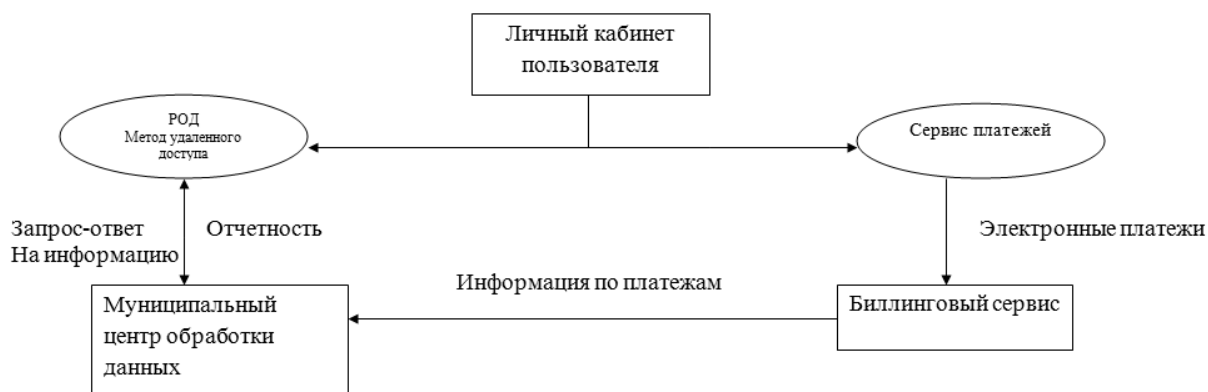
Рис. 3. Архитектура «Личного кабинета»
