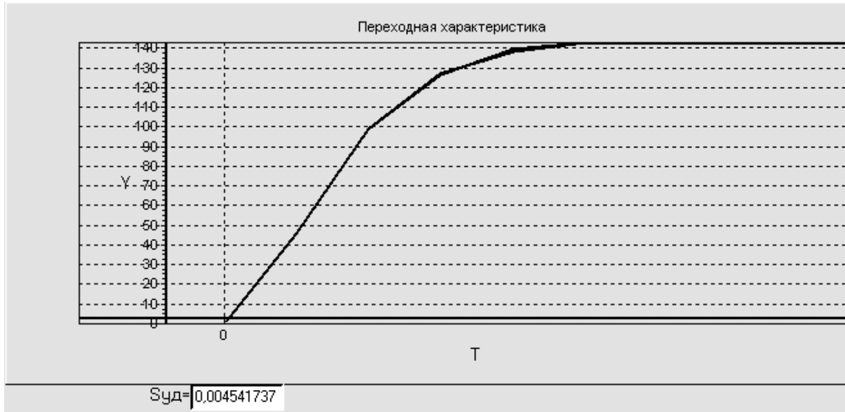
Рис. 3. Кривая разгона, полученная посредством разностного уравнения
