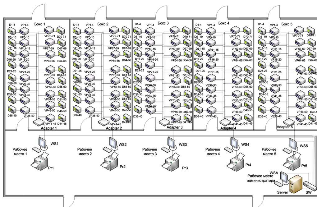
Рис. 1. Возможное расположение технических средств на испытательной станции
