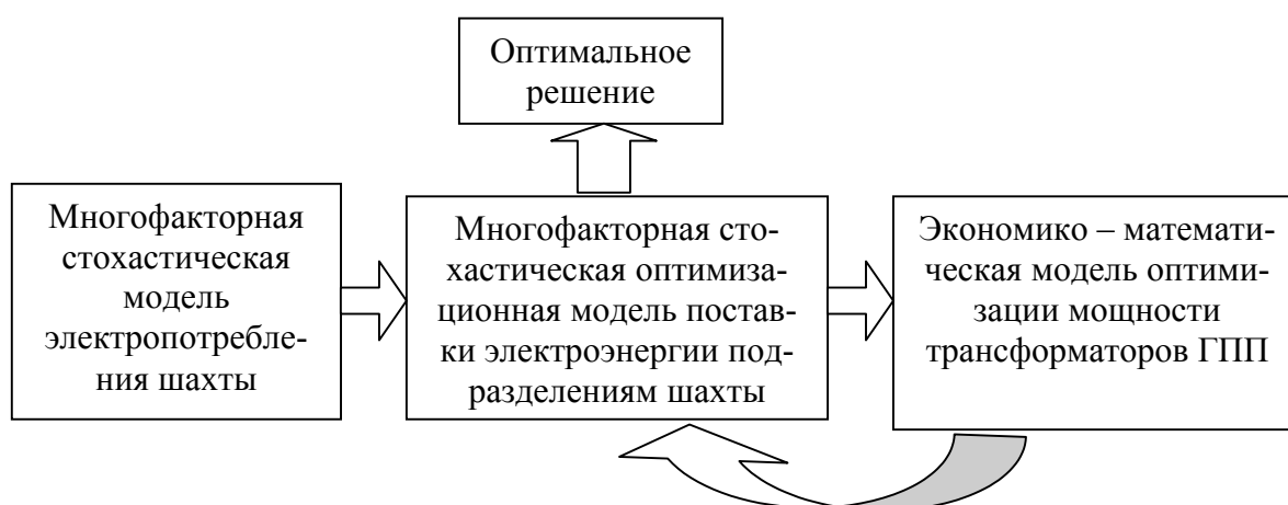
Рис.1. Структурная схема системы моделей оптимизации мощности источника питания угольной шахты
